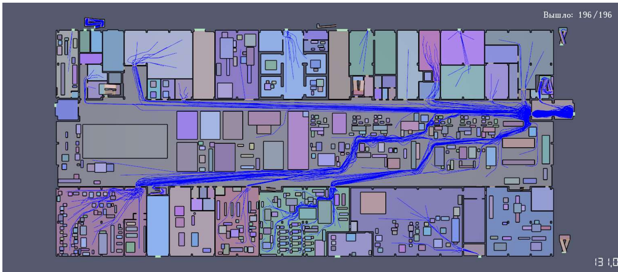
Рис. 2.1 Эвакуация людей из помещений 1 этажа
