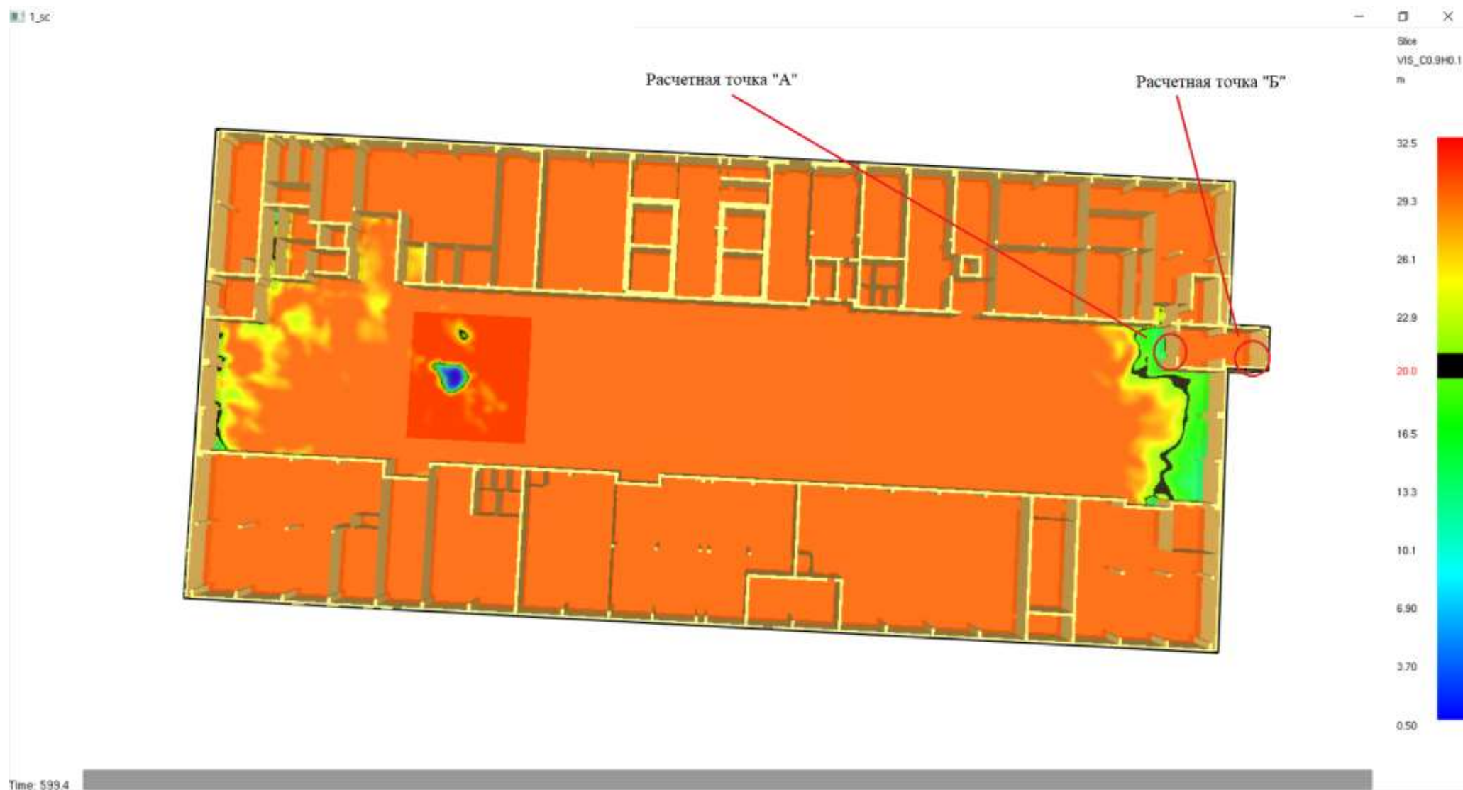
Рис. 9 Поля распределения опасных факторов пожара на 600 секунде (по потери видимости)
