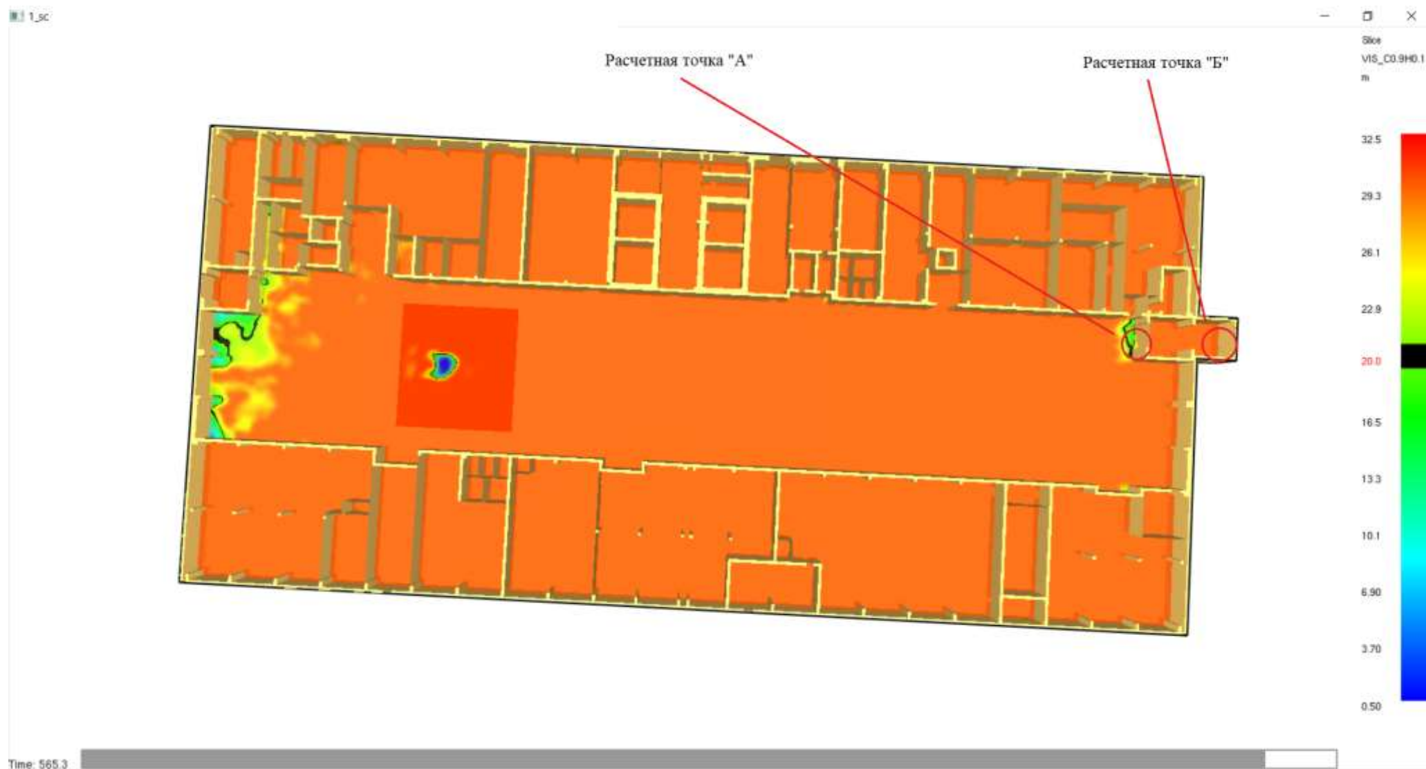
Рис. 8 Поля распределения опасных факторов пожара на 565 секунде (по потере видимости)
