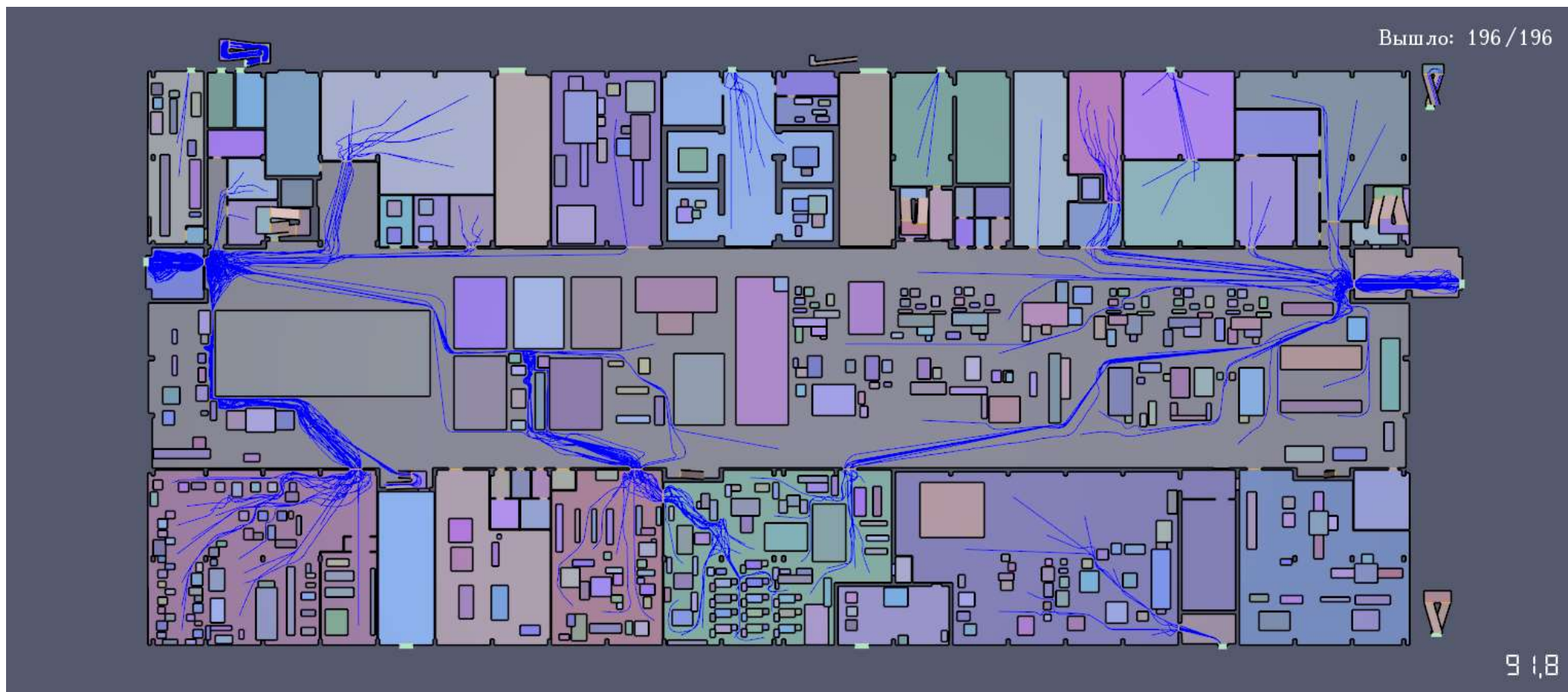
Рис. 6.1 Эвакуация людей из помещений 1 этажа
