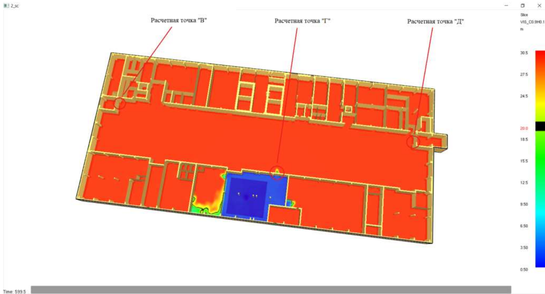
Рис. 12 Поля распределения опасных факторов пожара на 600 секунде (по потере видимости)
