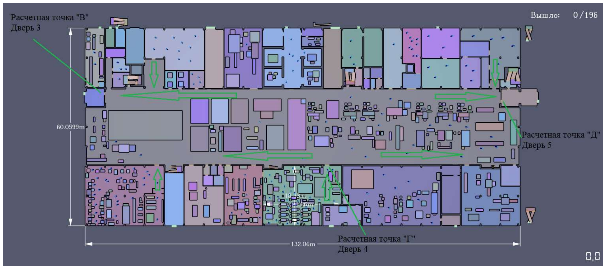
Рис. 3.2 Расчетная схема эвакуации и расположение людей на 1 этаже
