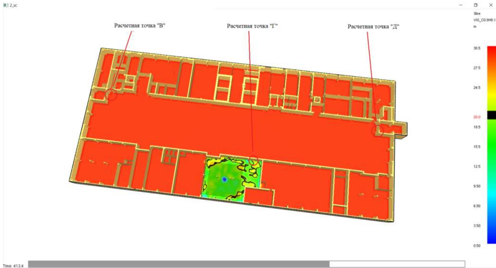
Рис. 11 Поля распределения опасных факторов пожара на 413 секунде (по потере видимости)
